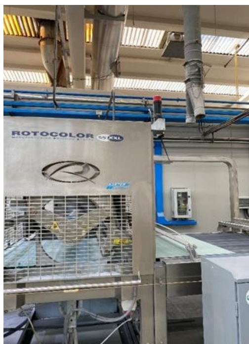
Slika 6. Rotocolor valjak za dekoriranje
