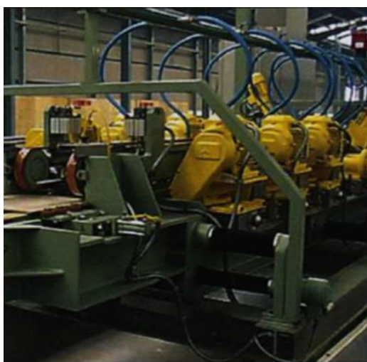
Slika 9. Proces retifikacije pločica
