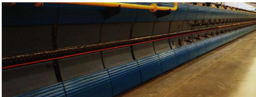
Slika 8. Peć u kojoj se odvija proces pečenja
