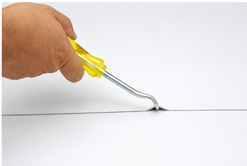
Slika 10. Prikaz ručne kontrole pomoću ispitivača vara [1]
