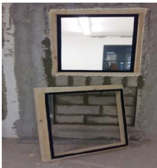
Slika 2. Ugradnja zvučno izoliranih ploča tijekom pokusa
