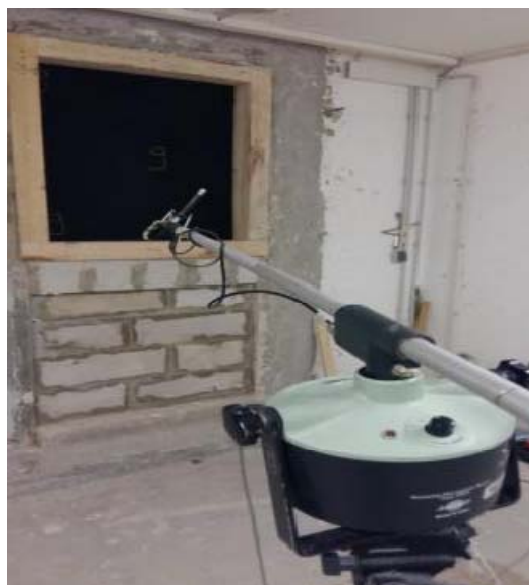
Slika 5. Opći izgled uređaja za primanje zvuka tijekom ispitivanja
