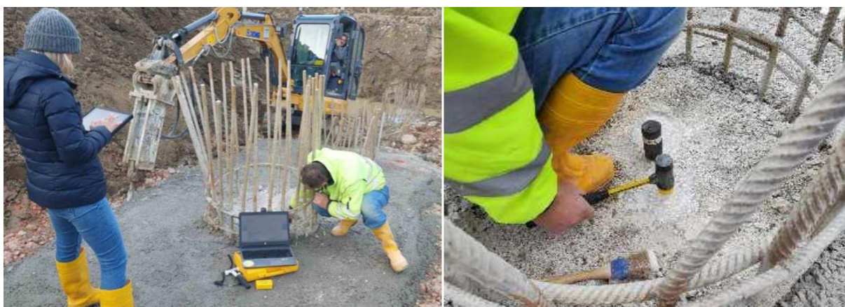
Slika 11. Ispitivanje integriteta pilota PET metodom (izrada autora)
