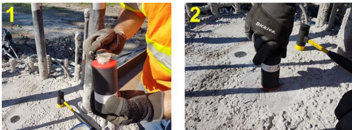
Slika 6. Način postavljanja senzora na glavu pilota [30]
