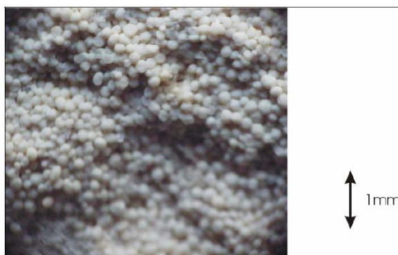
Slika 14. SEM 1 snimka oolitične strukture tenelije
