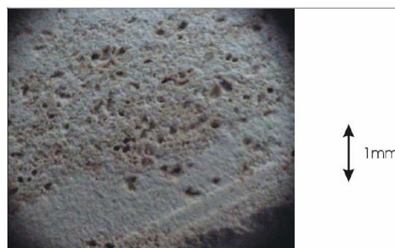
Slika 15. SEM 1 snimka sitnozrnate strukture miljevine
